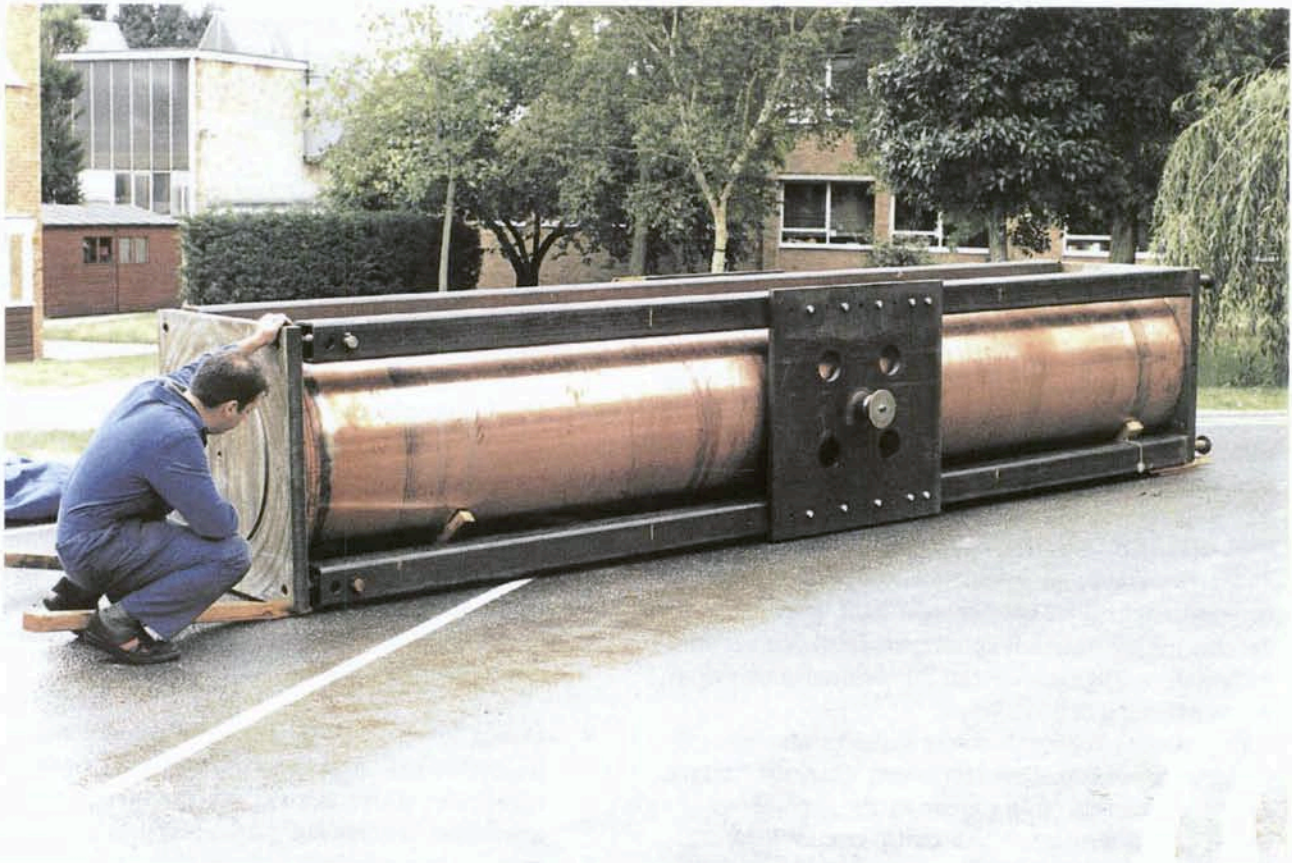
Figur 6-3. Fullskalekapsel från provtillverkning med självbärande inre stålkapsel.
